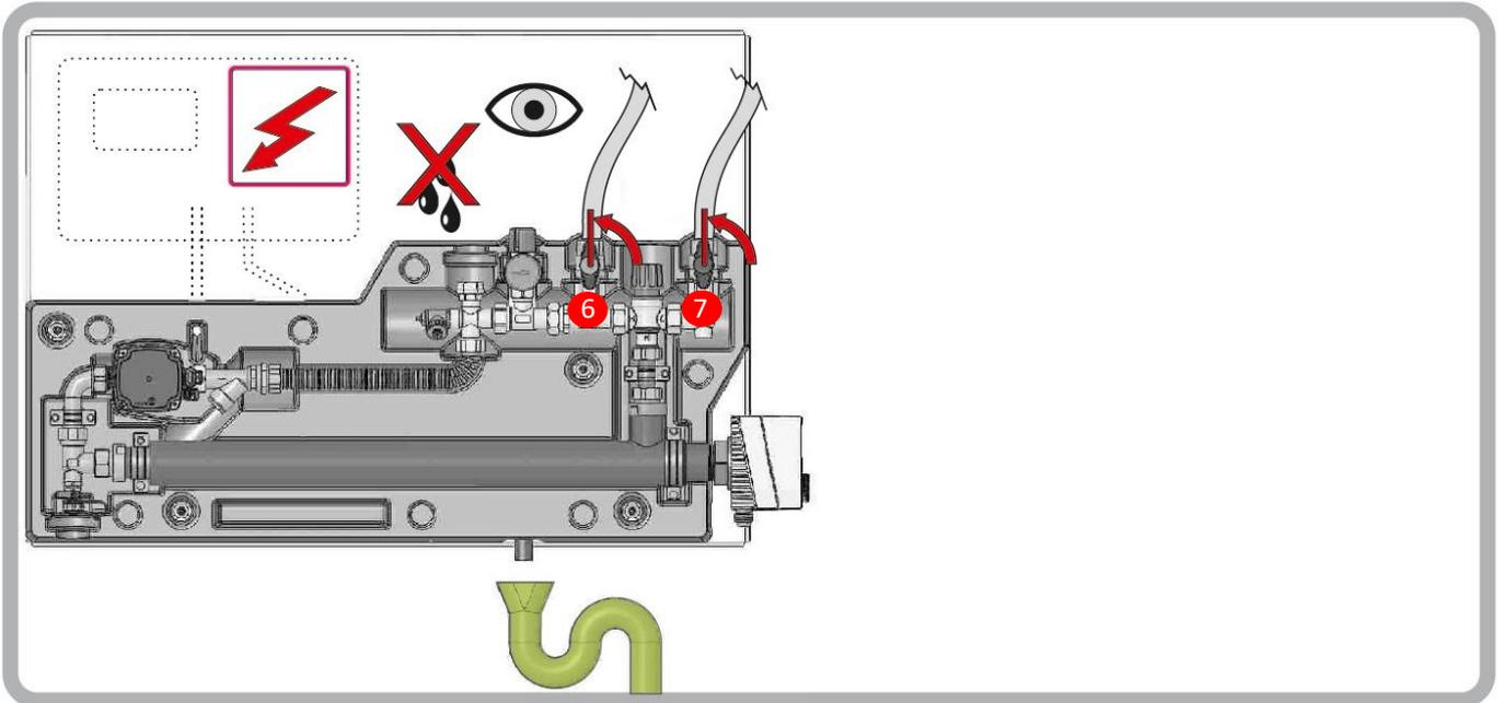
Nach dem Öffnen der beiden Absperrhähne für Vor- / Rücklauf (Nr. 6 & 7) muss die Anlage auf Dichtheit geprüft werden. Es darf kein Wasserausritt festgestellt werden. Sollte eine Verschraubung undicht sein, muss diese nachgezogen werden.
