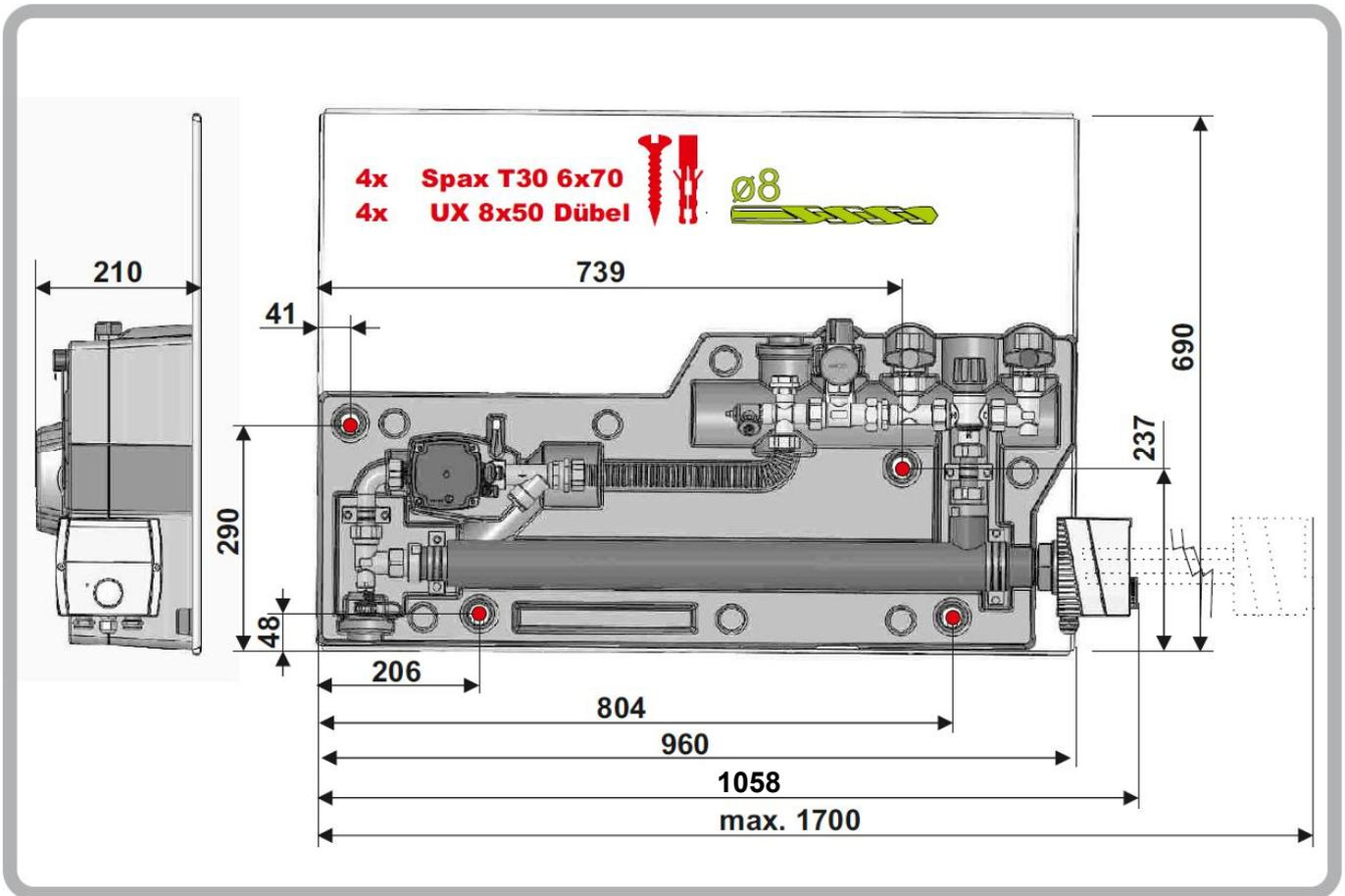
Die ASKOWALL kann mittels vier mitgelieferter Schrauben an der Wand befestigt werden.
