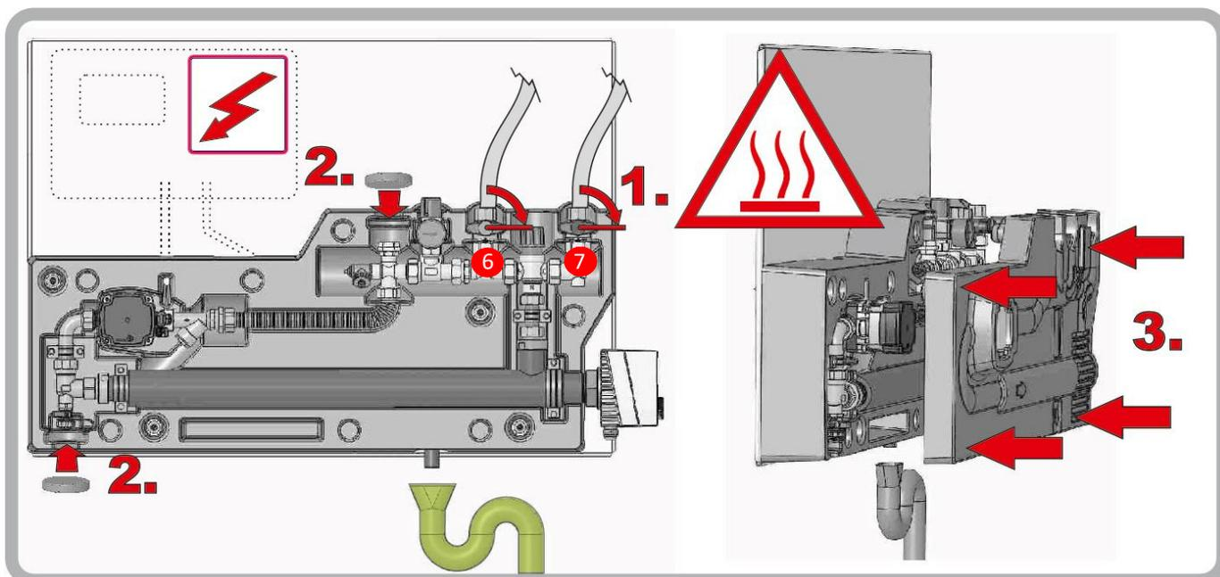
**ACHTUNG:** Vor dem Verschliessen der Isolationsabdeckung müssen die beiden Absperrhähne des Vorlaufs und Rücklaufs (Nr. 6 und Nr. 7) geschlossen werden. Die Isolationsabdeckung lässt sich sonst nicht schliessen.
